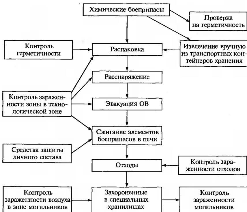
Рис. 12.19. Сжигание элементов химических боеприпасов в печи
