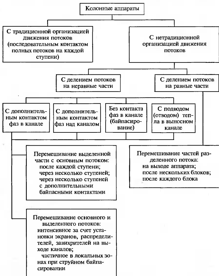
Рис. 4.10. Классификация колонных аппаратов по организации движения потока легкой фазы
